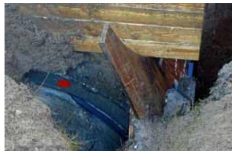
Herausdrückende Dichtung in Druckleitung
