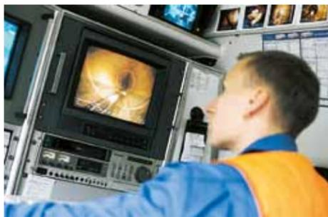
Kanalinspektion mit selbstfahrender Kamera
