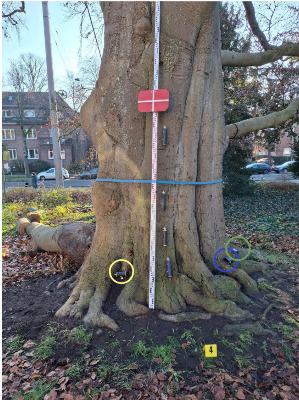
Abb. 5: Position der Sensoren zur Standsicherheit (Messung IV.).
