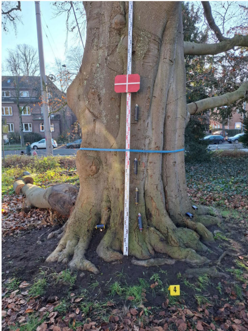
Abb. 6: Position der Sensoren zur Bruchsicherheit (Messung IV.).
