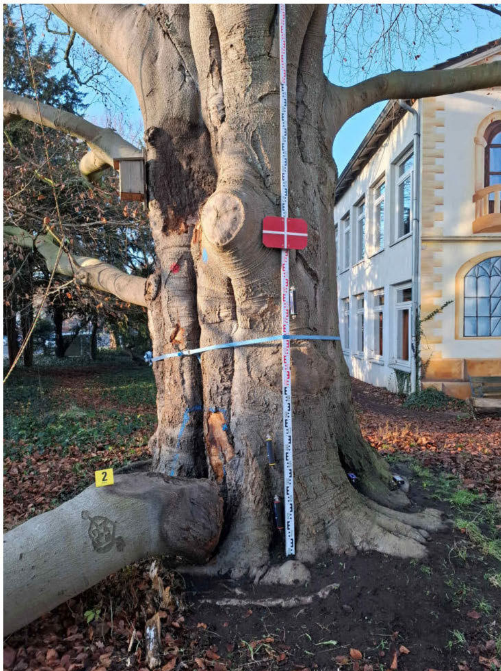
Abb. 4: Position der Sensoren zur Bruchsicherheit (Messung II.).
