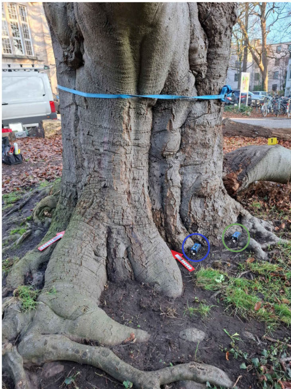
Abb. 3: Position der Sensoren zur Standsicherheit (Messung II.). Die roten Pfeile markieren Position von Pilzfruchtkörpern von der Brandkruste.
